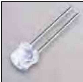
激光二极管W型封装
