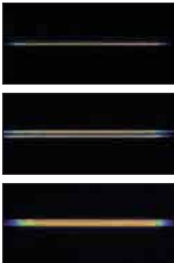
激光二极管一, 二, 三外延层光近场比较
