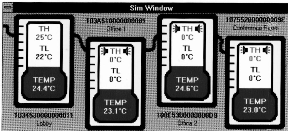
The DS1820K demonstration kit allows a potential user of the DS1820 to observe the operation of the DS1820 in an actual, multipoint temperature measurement application.
