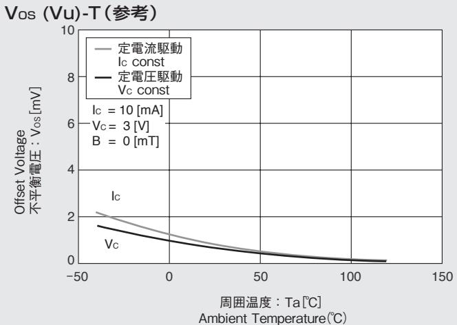
定電圧駆動  $Rin=425[\Omega]$ 、 $Vos=0.8[mV]$  [ $Vc=3[V]$ ] の例
