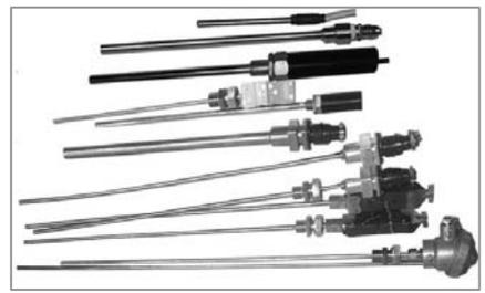
铠装式热电阻主要以 Pt100 作为感温元件，进口薄膜铂电阻具有测量精度高、反应速度快，动态误差小等特点。铠装式热电阻可以测量-200~600℃范围内的气体、液体和蒸汽及固体表面或内部温度。
