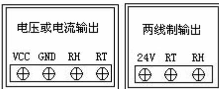
电压/电流信号输出 两线制电流信号输出
