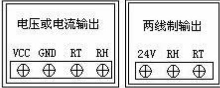
RT: 温度信号输出 RH: 湿度信号输出 GND: 直流地 VCC: 工作电源, 据需要可选 12V/24V
