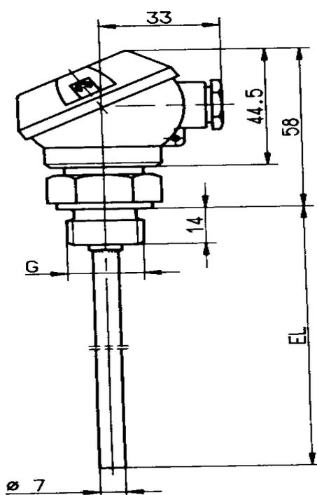
图 7. 拧入式 J 型端子头 90.101-F02 型热偶外形尺寸 2
