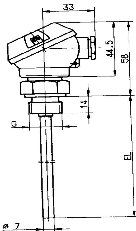
图 6. 拧入式 J 型端子头热偶外形尺寸 1
