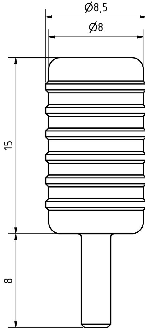
Geeignet für POF-Fasern mit Außendurchmesser 1,5mm oder 2,2mm zum Anschluß an Fiberpoint® 250MD und Fiberpoint® ET.
