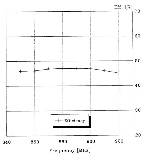
Pin=0dBm, Pout=1.2W, Vs=6V
