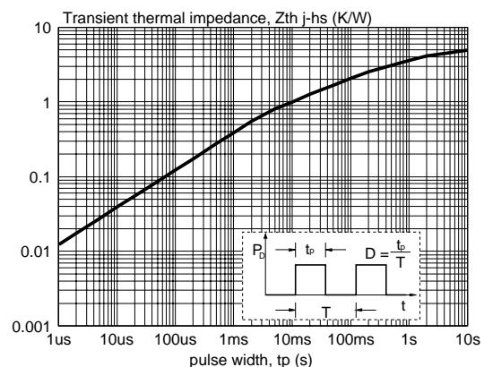
Fig.11. Transient thermal impedance; per diode;
