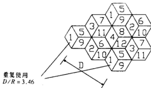
图 3.0.3-2  $4 \times 3$  频率复用方式
