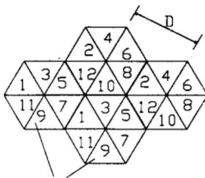
图 3.0.3-4  $2 \times 6$  频率复用方式
