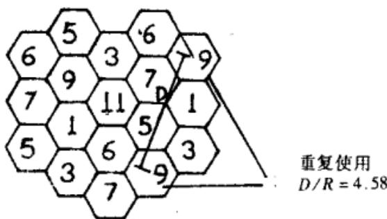
图 3.0.3-1  $N=7$  频率复用方式
