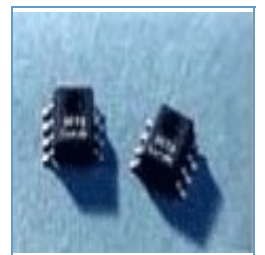
名称: 轮胎压力传感器 NPP301
