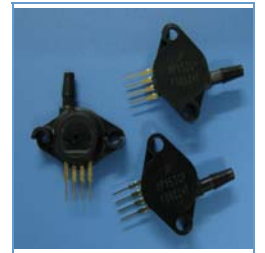
名称: MPX53GP 硅压力传感器
