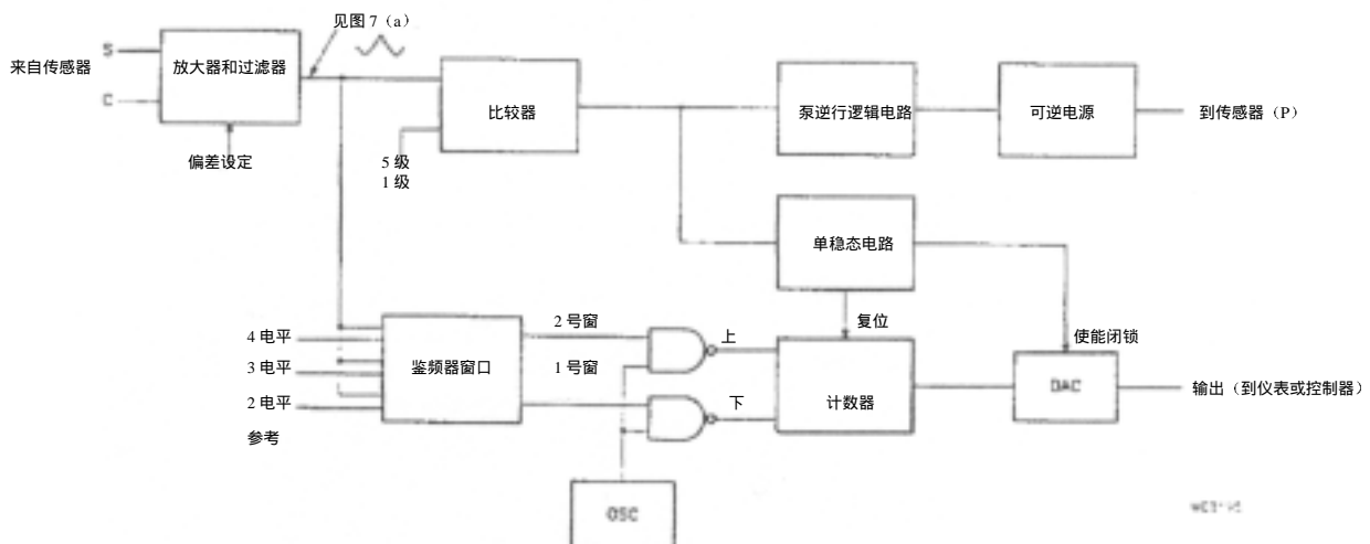
图 6 按 TC=0 模式 (零温度系数) 操作的 KGZ10 控制电路示意图
