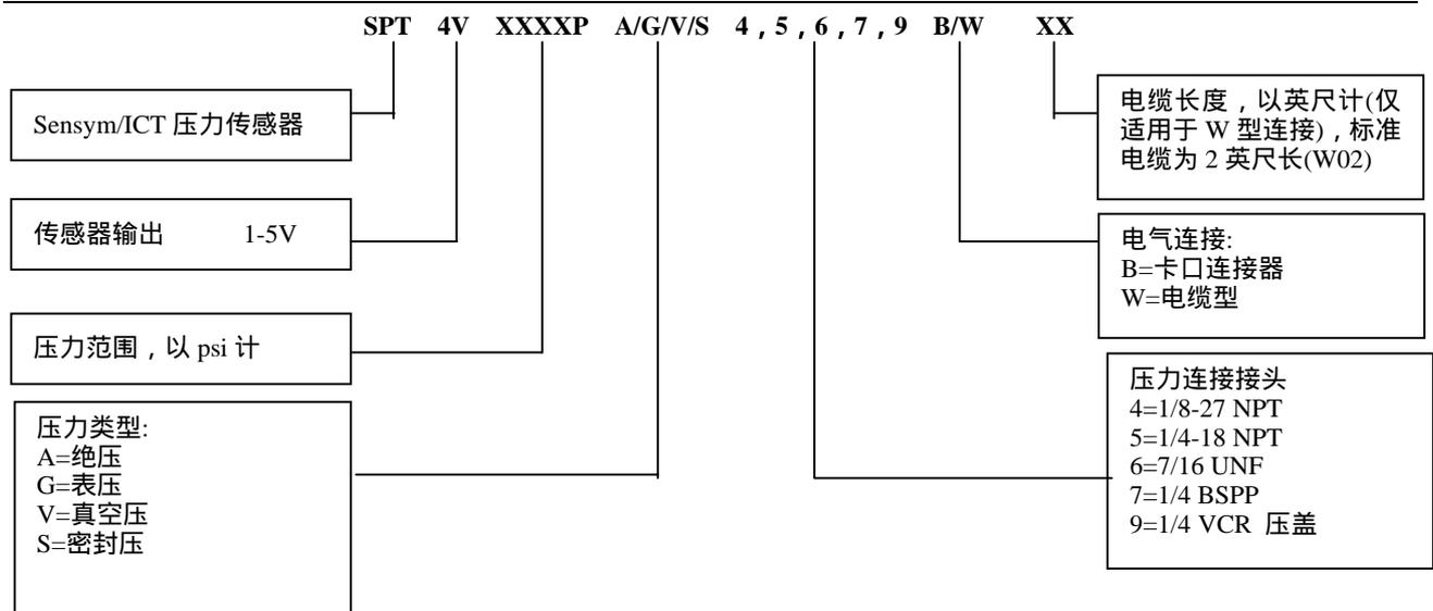
例如: 部件号 **SPT4V0100PA4W02**=SPT 4V 传感器，100psi，绝压，1/8 NPT 压力孔，配有 2 英尺长的电缆(引出端)，用于电气连接。
