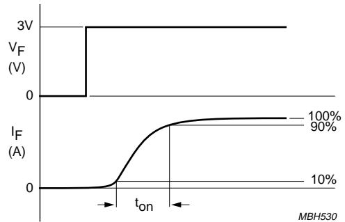
Input impedance oscilloscope:  $1 \text{ M}\Omega$ ,  $22 \text{ pF}$ ;  $t_r \leq 7 \text{ ns}$ .
