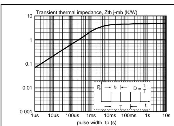
Fig.6. Transient thermal impedance per diode;
