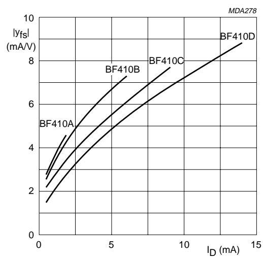
Fig.3  $V_{DS} 10 \text{ V}$ ;  $f = 1 \text{ kHz}$ ;  $T_{amb} = 25^\circ\text{C}$ ; typical values.
